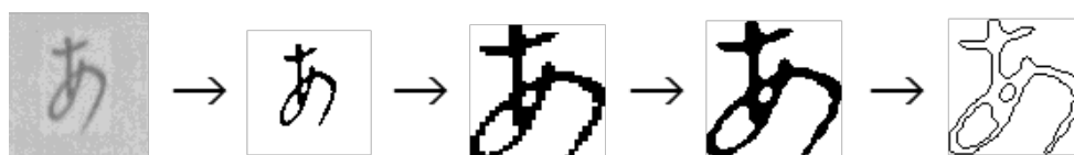
図 II.3 画像の整形から輪郭線抽出までの流れ
